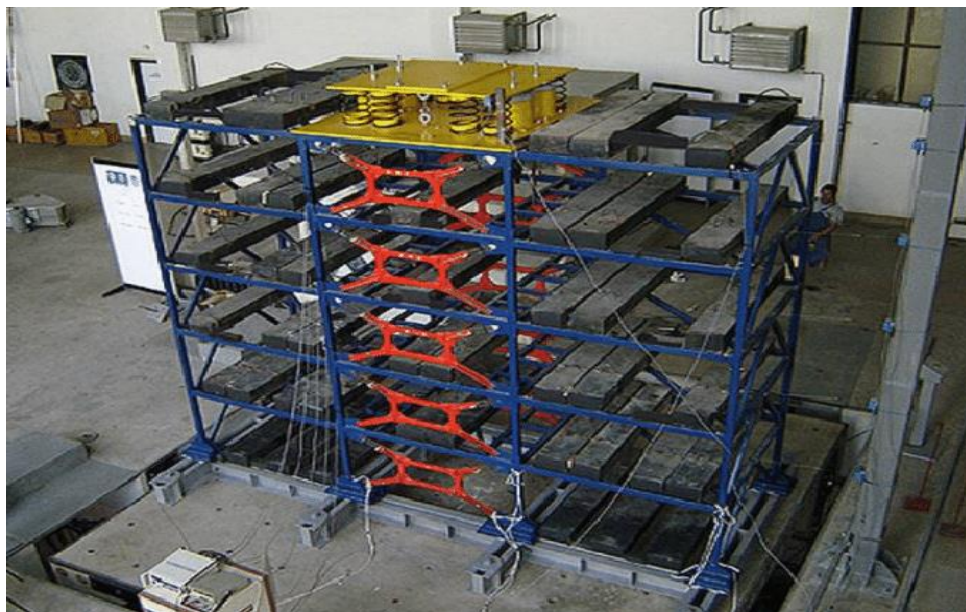
Fig: Shaking Table Test(STT)
