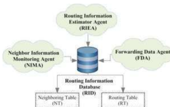
Fig. 2: The 3 sensor node modules, viz., NIMA, RIEA & the FDA
