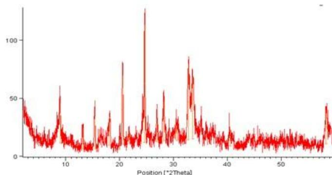
Fig. 9 : XRD analysis of Zn(II) $H_2L$
