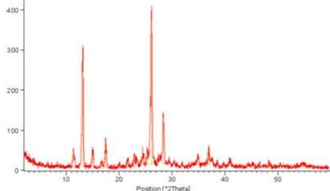
Fig. 6 : XRD analysis of ligand  $H_2L$
