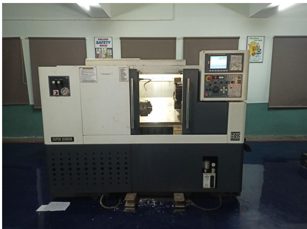
Fig. 6. CNC machine (Turning)
